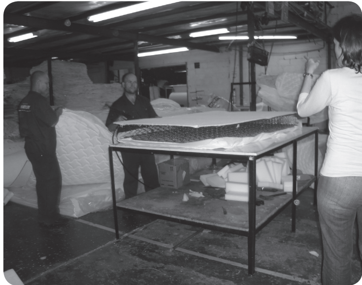
Recubrimiento del armazón y colocación de espuma.
